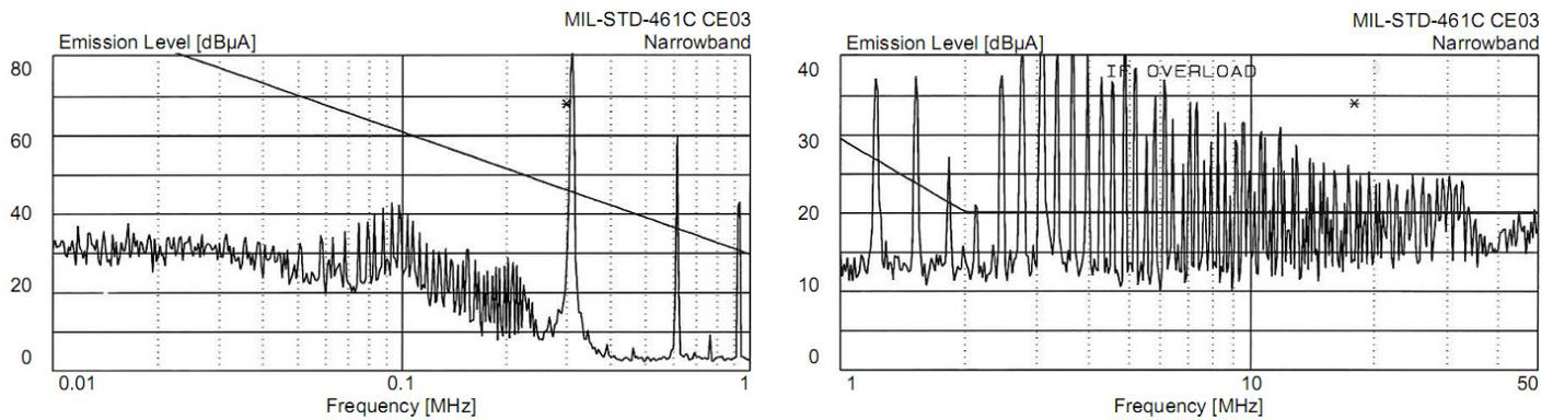
**Figure 7** – 5V input line, DVPL,  $C_{IN}=100\mu F$
